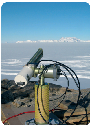
Afbeelding 4.5 : (links): De CIMEL-zonfotometer op de Prinses Elisabeth basis meet de totale verzwakking van het zonlicht door aerosoldeeltjes. (boven): Aerosol optische dikte (maat voor de verzwakking van het zonlicht) en geïntegreerde waterkolom (hoeveelheid water in de atmosfeer dat kan neerslaan) op 16 februari 2009 gemeten door de zonfotometer.
