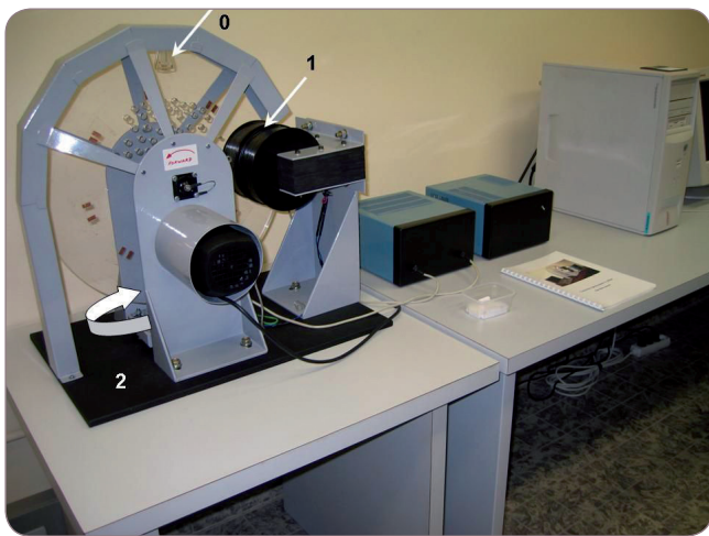
Afbeelding 3.2: Hysteresiskurven worden bekomen met een rotatie-magnetometer. Het staal wordt gemonteerd aan de binnenkant van de plexiglazen schijf (pijl 0). Tijdens de draaibeweging van de schijf, neemt de intensiteit van het magneetveld met stappen toe, telkens wanneer de staal de luchtspleet van de elektromagneet passeert (pijl 1) waar de geïnduceerde magnetisatie wordt gemeten. De remanente magnetisatie wordt gemeten in een andere detectiespoel (pijl 2), die zich in het nulveld bevindt.
